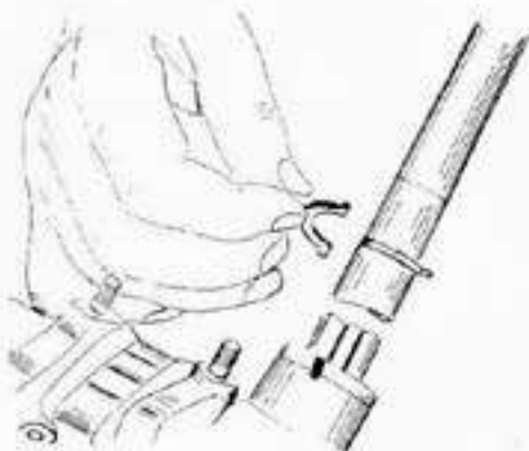
Bild 26 Die Lenksäule wird mit dem Ritzel und der zweiteiligen Sicherung herausgezogen.
