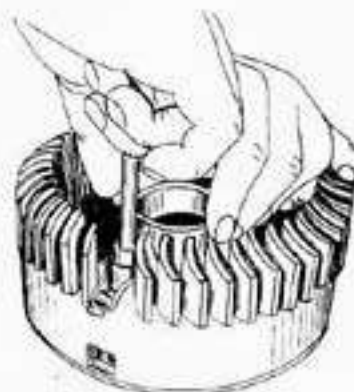
Bild 89 Mit 11 mm Sechskant Schlüssel werden die Einstellmutter der Kupplung gedreht, bis die Ausrückhebel gleichzeitig auf der Leibe aufliegen. Nach dem mit Stecker sichern.
