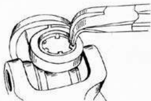
Bild 35 Mit der abgelegenen Nase nach innen (Druck gegen die Nadellagerböcken) wird der Saegering beim Kreuzgelenk eingesteckt.
