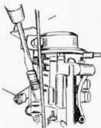
Bild 77 Einstellen der Lohlaufregulierschraube Bei zu schnellem Leerlauf einstellen Schaltbeschleuniger und bei zu wenig Motorleistung stellt dieser ab.
