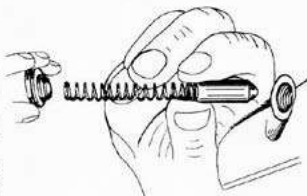
Bild 38 Die Feder der Schaltbetätigung ist kalibriert und darf nicht gestreckt oder zusammengepresst werden.
