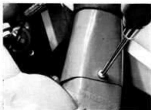
5. Heizschlauch mit Anschlußstück demontieren.
