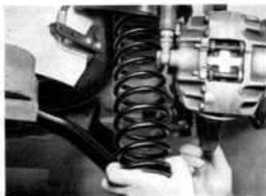
7. Feder entspannen. Querlenker nach unten drücken und Feder abnehmen.
