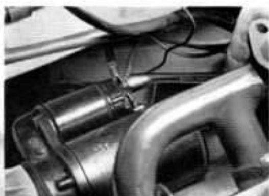
7. Anlasserkabel lösen. Schwarzes Kabel 16 mm 2 von Batterie + und rotes Kabel von B + liegen an der Klemme 30, grünes Kabel an Zündschalter.
