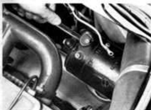
8. Lichtmaschinenkabel lösen. Schwarzes Kabel mit geschlitzter Polklemme an DF. Schwarzes umhülltes Kabel mit gelochter Polklemme an D +. Weißes Kabel an D —.
