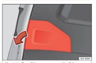
Fig. 112 Rear lid open: remove the lid.
