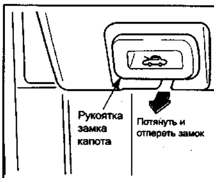
Рис. 46. Расположение и направление перемещения ручки замка капота
