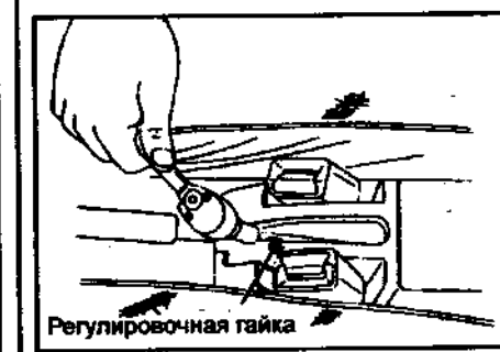
3. Вращая регулировочную гайку, отрегулируйте стояночный тормоз так, чтобы при затягивании рычага усилием 10 кг он поднимался на 5–7 щелчков.
