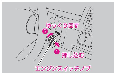
⑤アクセルペダルを踏まずに、エンジンスイッチをゆっくりと“III”まで回し、エンジンが始動したら手を離してください。自動的に“II”に戻ります。
