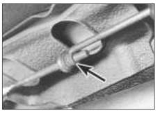
16.2 Handbrake adjuster nuts
