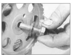
5B.22B Camshaft sprocket bolt and washer
