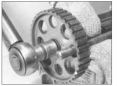
5B.22A Unscrewing the camshaft sprocket bolt
