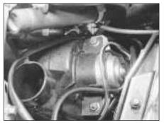
9C.85 Fuel injector cooling fan
